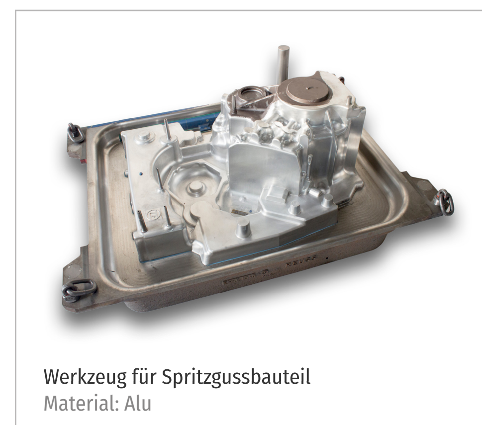
Werkzeug für Spritzgussbauteil Material: Alu
