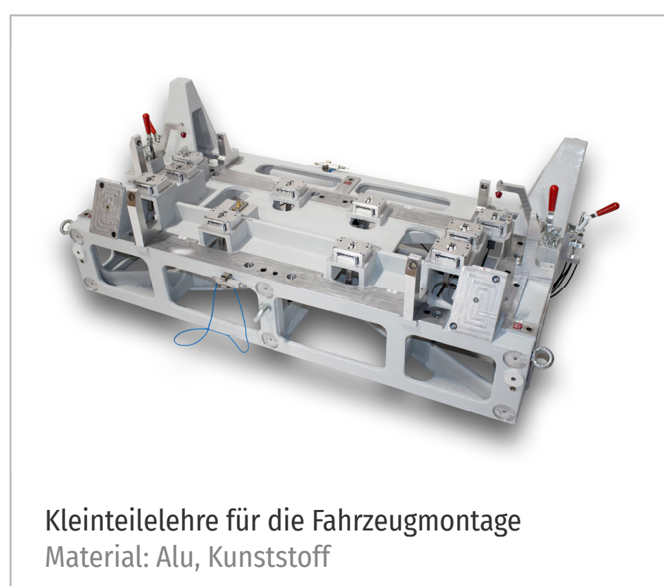
Kleinteilelehre für die Fahrzeugmontage Material: Alu, Kunststoff
